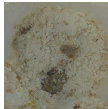
Obr. 31 – Příklad úplného zhroucení hmoty NBR + stěpy vystaveného 30% CH_2O_2 po 120 dní
