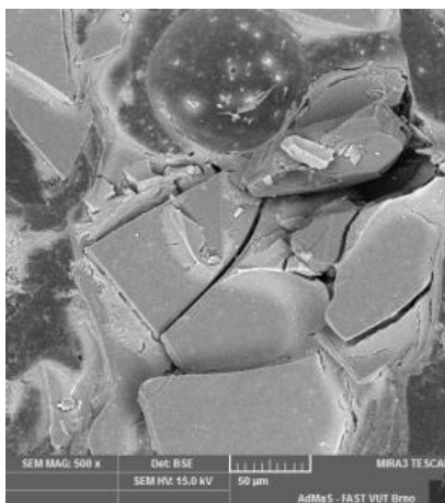
Obr. 39 – REM snímek hmoty NBR + skleněné vločky, \text{HC}_2\text{O}_2 90dní – zvětšení 500x
