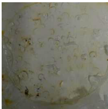
Obr. 30 – Příklad popraskání hmoty NBR + zaoblené částice vystavené 30% CH_2O_2 po 60 dní
