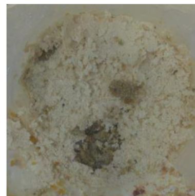
Obr. 31 – Příklad úplného zhroucení hmoty NBR + střepey vystaveného 30% CH_2O_2 po 120 dní
