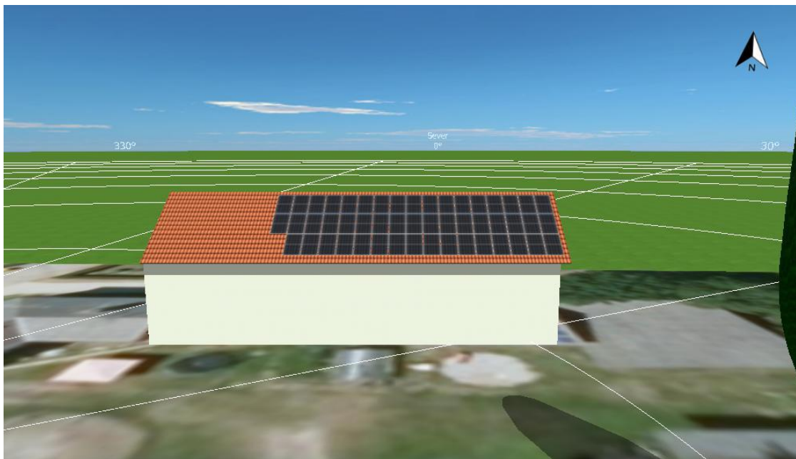
Obrázek 7-7 3D návrh FVE s instalovaným výkonem 15,75 kWp
