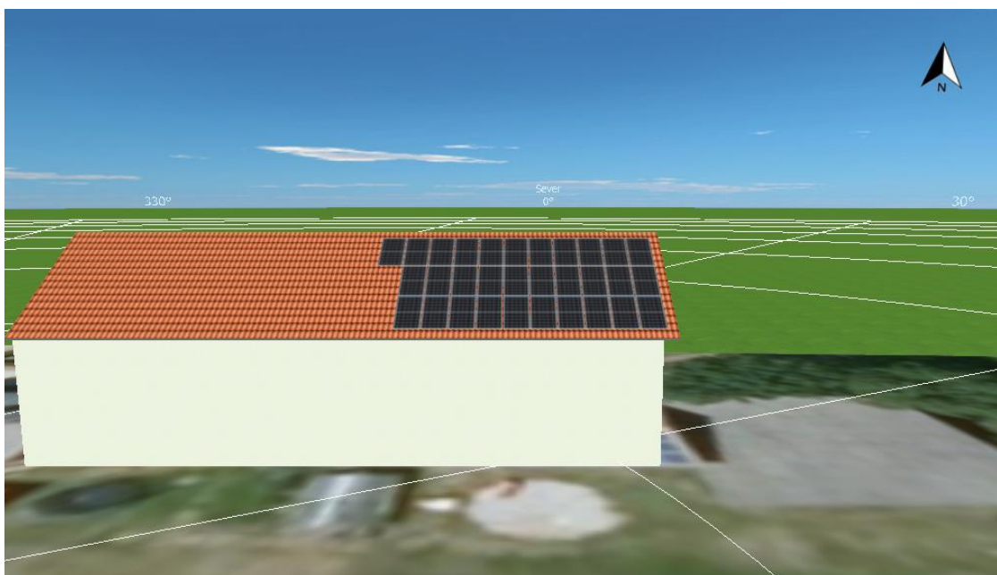
Obrázek 7-9 3D návrh FVE s instalovaným výkonem 9,77 kWp
