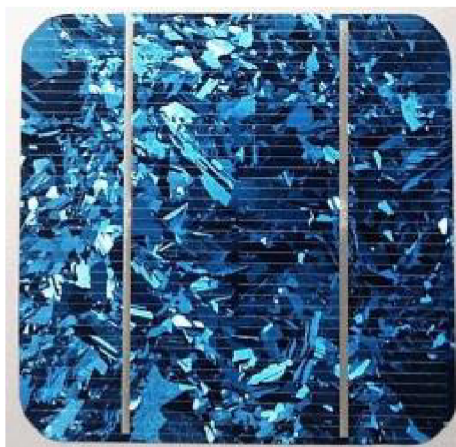
Obrázek 2-4 Struktura křemíkového článku [8]
