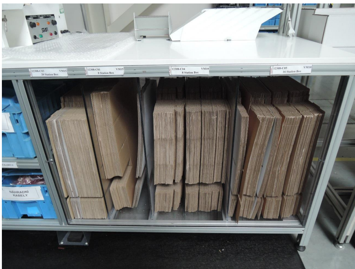
Obr. 5: Skladovanie obalového materiálu vo výrobe s využitím konštrukcie
