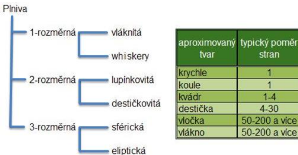
Obrázek č. 8: Rozdělení částic plniva dle tvaru s charakteristickým poměrem stran [30]
