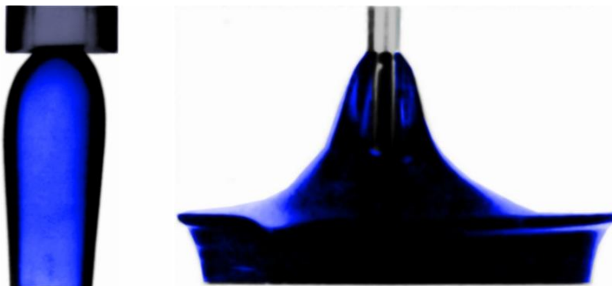
Obrázek č. 24: Chování neneutonských kapalin Barusův efekt (vlevo), Weissenbergův efekt (vpravo) [30]
