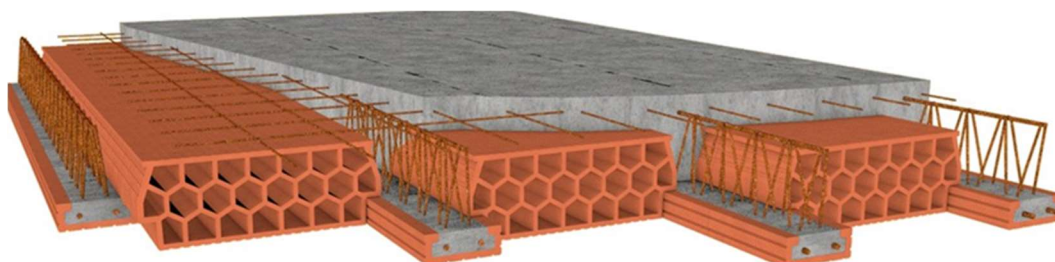
Obrázek 21: Vložky Miako s nosníky, pohled na strop [45].
