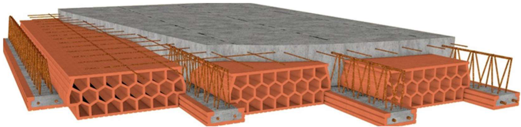
Obrázek 21: Vložky Miako s nosníky, pohled na strop [45].
