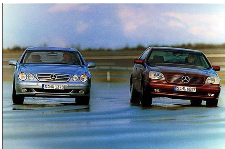
Obr. 20 Náklon karoserie při průjezdu zatáčkou se systémem ABC a bez něj
