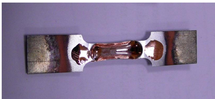
Obrázek 17: Lodička použitá při napařování měděného filmu
