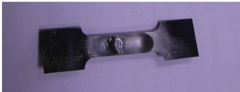
Obrázek 20: Lodička použitá při napařování stříbrného filmu
