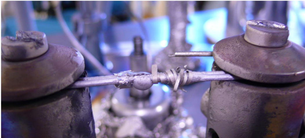
Obrázek 25: Drátový výparník použitý pro napařování niklu
