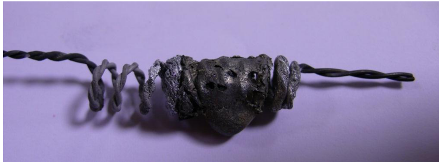
Obrázek 23: Drátový výparník použitý pro napařování hliníku
