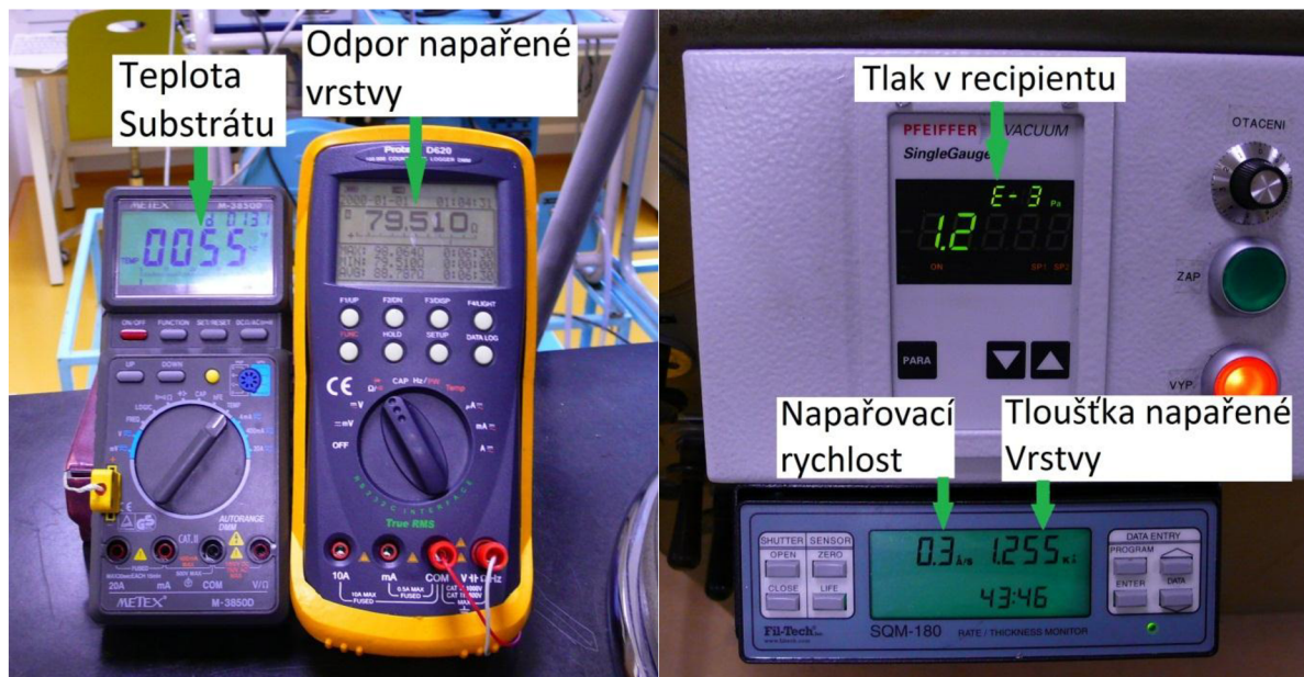
Obrázek 9: Měřicí a zobrazovací technika pro parametry napařené vrstvy
