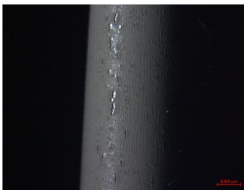
Obrázek 39. Porušení práškového nátěru přes 2 mm válec
