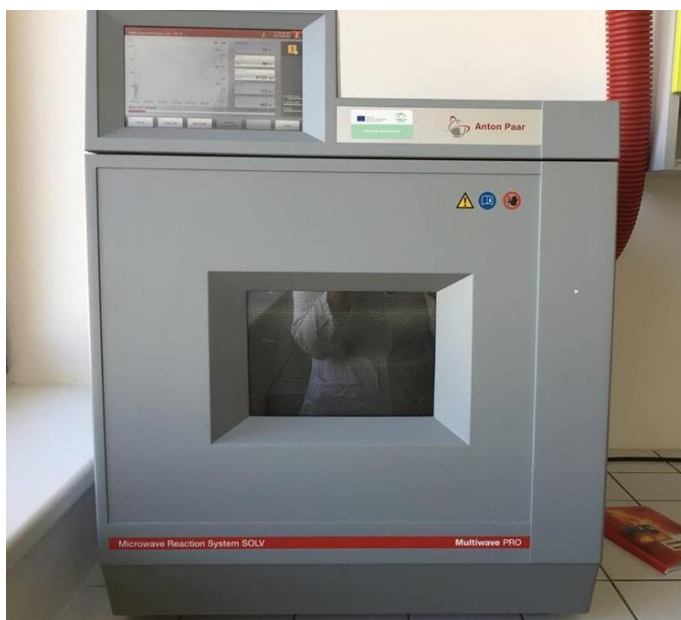
Obrázek 6: Použité zařízení pro mikrovlnný rozklad. Zdroj: autor, 2016
