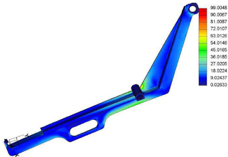
Obrázek 4-4 - Stress von Mises [MPa].
