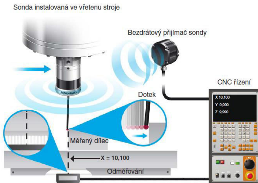
Obrázek 2-2 - Schéma dotekové sondy [8].
