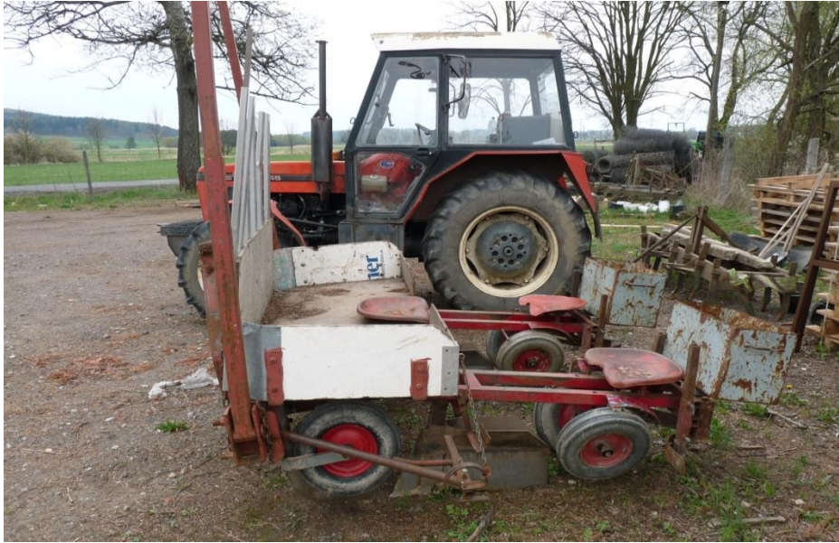
Příloha 5 Rýhový sázecí stroj značky Egedal, sázecí stroj je nesený za traktorem s předním náhonem (foto Vlasák 2013).
