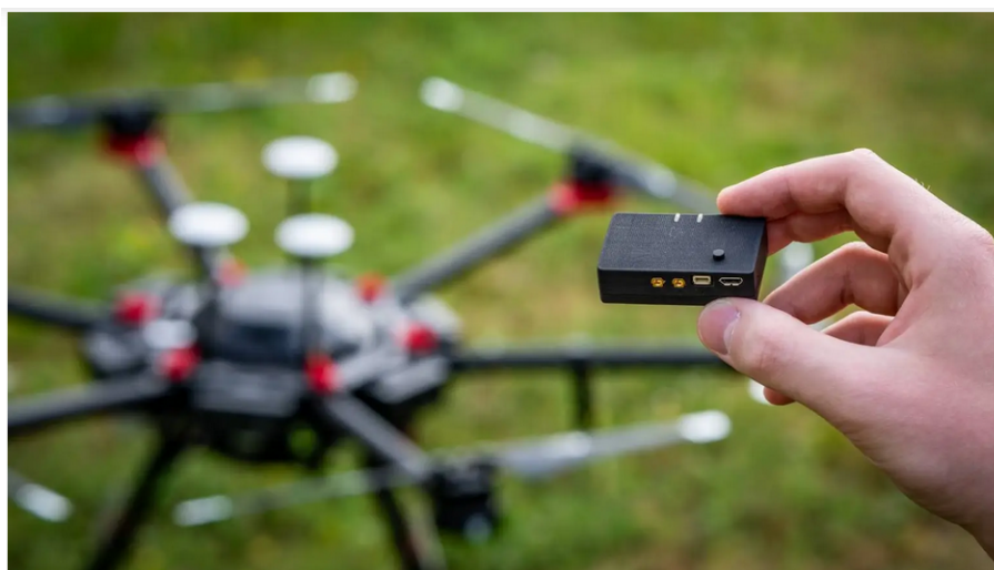
Obrázek 5.1: Zařízení pro dálkovou identifikaci
