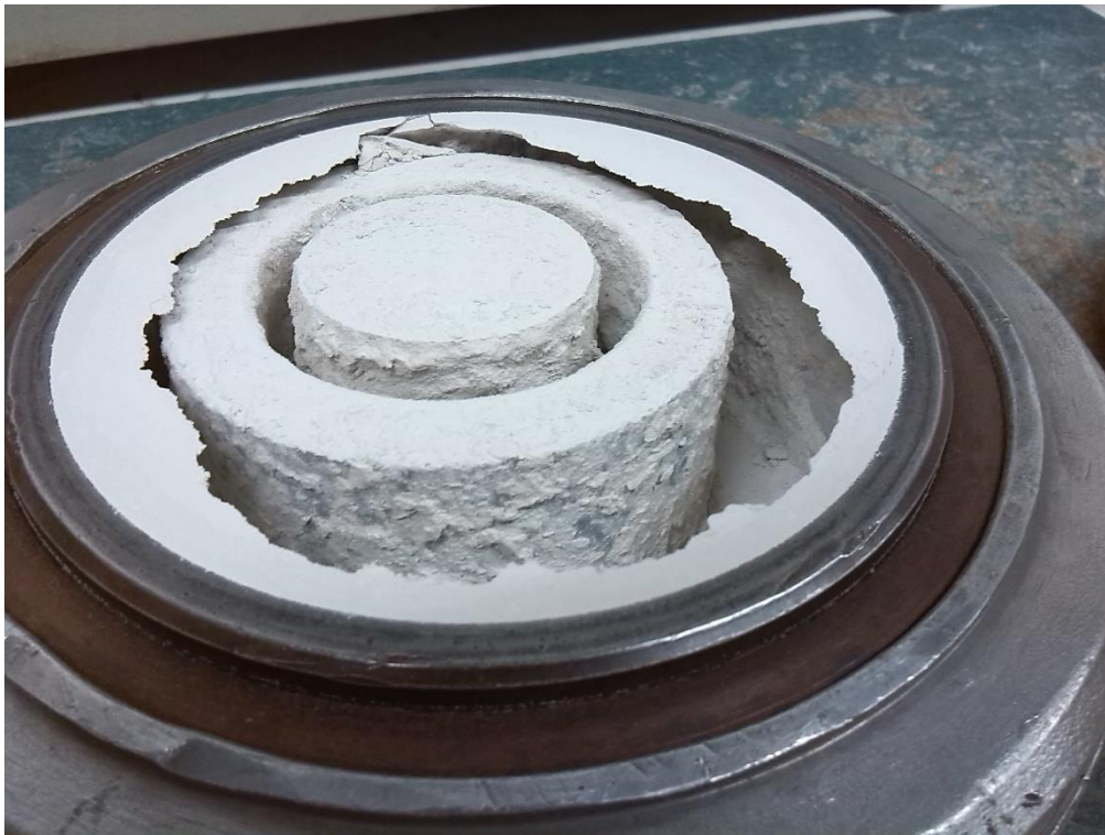
Obrázek 15: Mlecí tableta s poduškou vytvořenou na stěnách a mlecích tělesech
