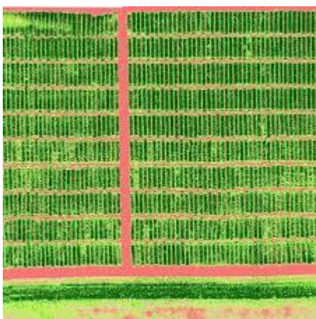
Obrázek 5 - ortofotomapa - normalizovaný vegetační index, podle kterého lze vytvořit aplikační mapu pro zemědělské stroje, které samy automaticky přizpůsobí potřebné hnojení dle mapy
