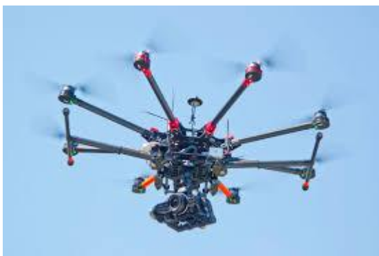
Obrázek 3 - Oktokoptéra DJI S1000 - označují se podle počtu motorů a vrtulí
