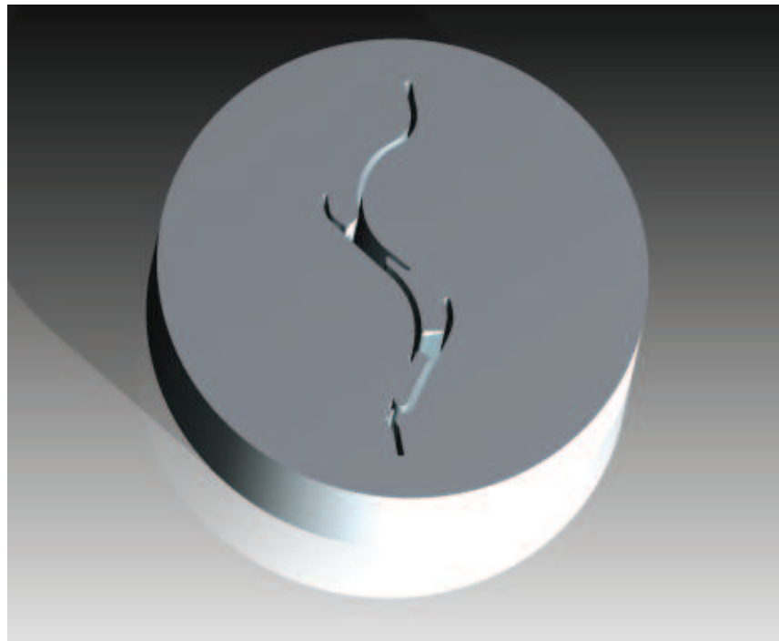
Obr. 3.2 Model vybrané protlačovací hubice
