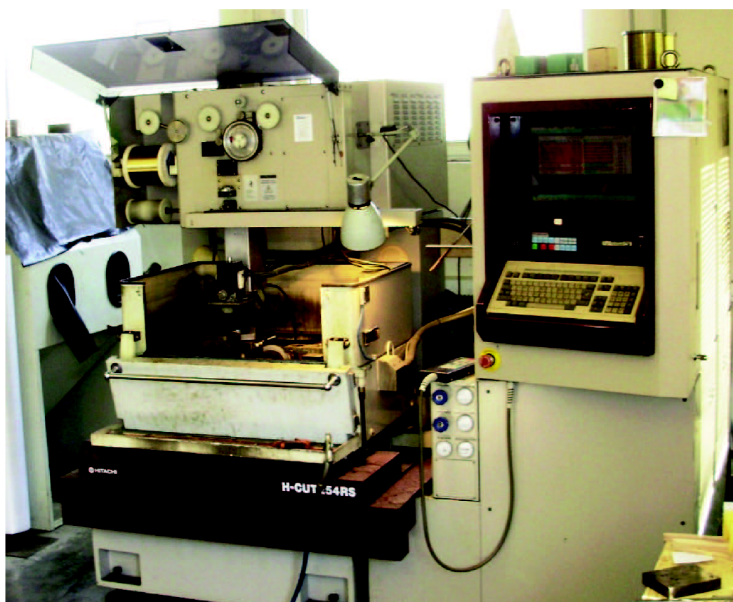
Obr. 2.3 Elektroerozivní drátová řezačka HITACHI 245R
