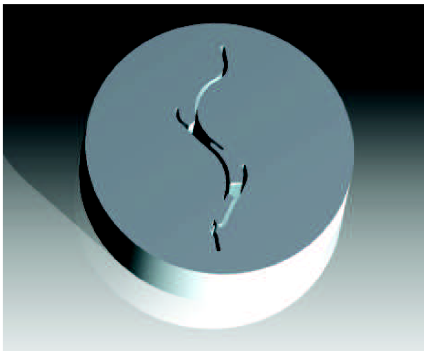
Obr. 3.2 Model vybrané protlačovací hubice
