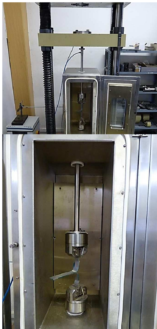
Obr. 3.5.6 Zkouška pevnosti v odlupování dle ISO 11 339
