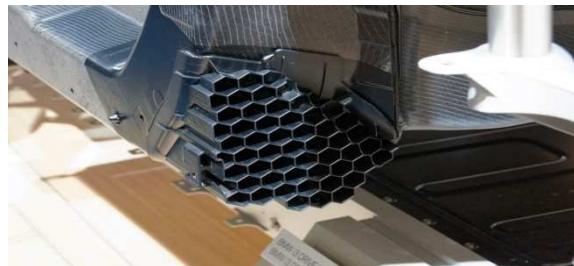
Obr. 2.2.4 Využití CFRP kompozitů u vozů BMW i3 [21]
