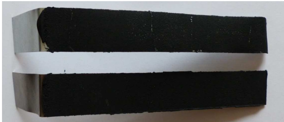
Obr. 3.5.8 Porušení spojů lepidla BETAGUARD RB 214 BV v kombinaci materiálů HDG-CRS
