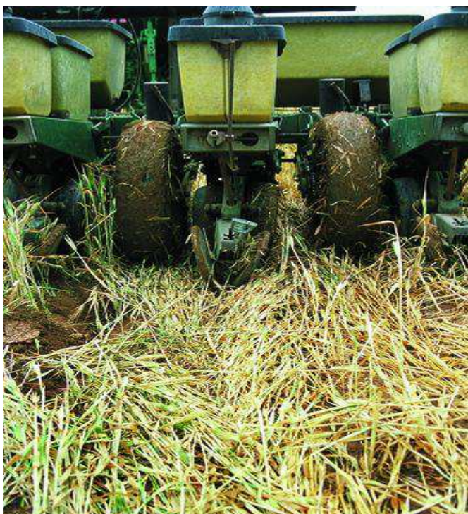
OBRÁZEK č. 16 Bezorebné setí kukuřice do strniště ječmene, Washington County, Virginia, USA (NRCS-photo, 2012)
