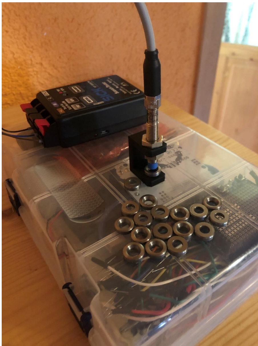
Obr. 18 Pokus - nesprávně orientované sedlo
