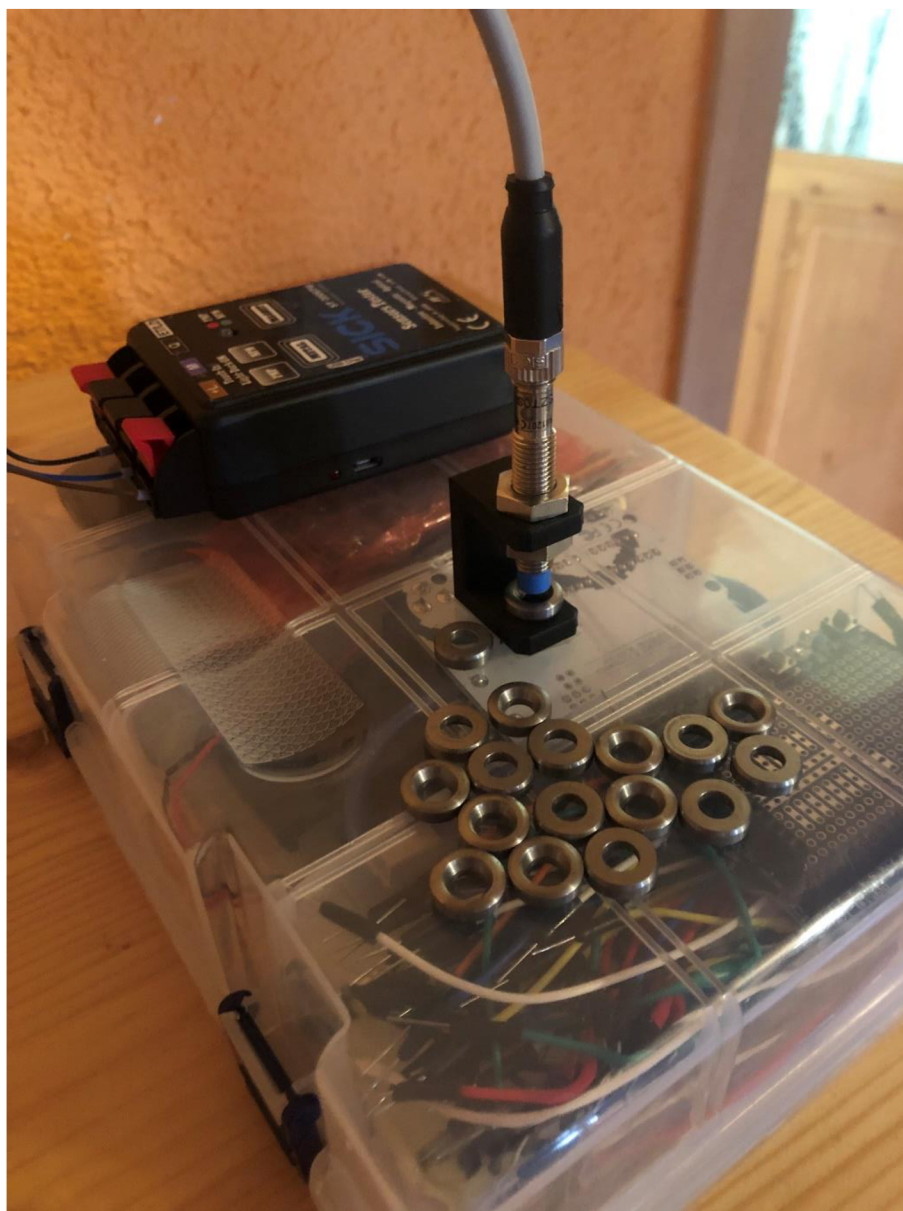
Obr. 18 Pokus - nesprávně orientované sedlo
