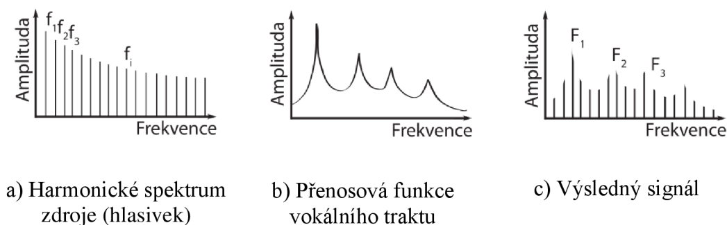
Obr. 5: Formování frekvenčního spektra samohlásky podle teorie zdroj-filtr. [7] [10]
