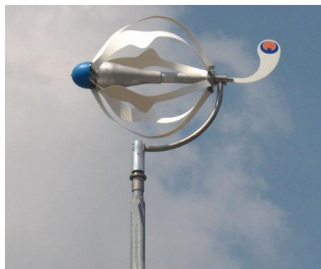
Obrázek 2-3 Turbína Energy ball [11]
