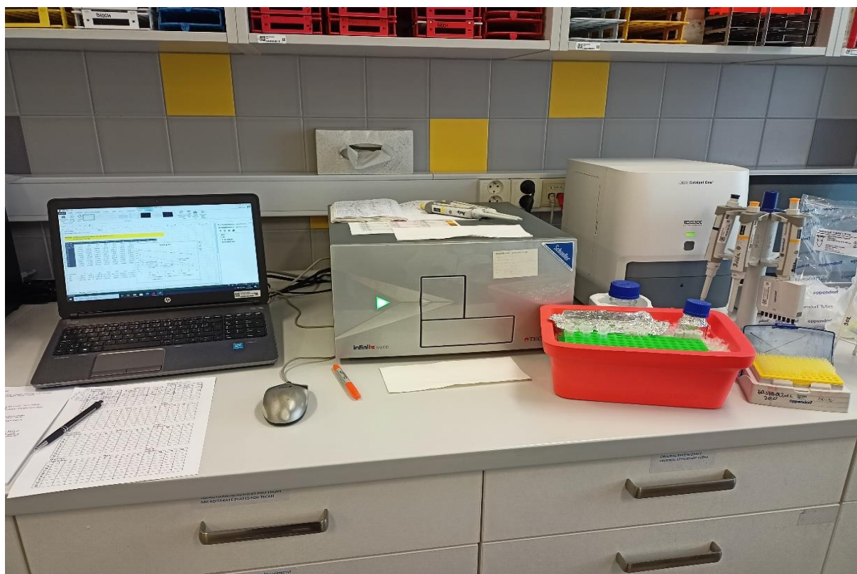
Obr. č. 8. Spektrofotometr Tecan Infinite M200, s dalším laboratorním vybavením sloužící ke stanovování biomarkerů, v tomto případě katalázy.
