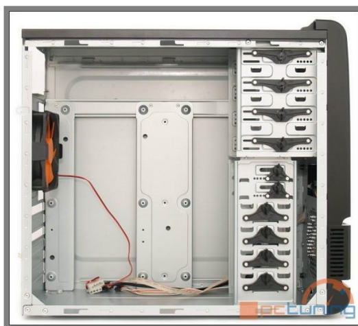
Obr. 7 Vnitřní konstrukce PC skříně, [14]
