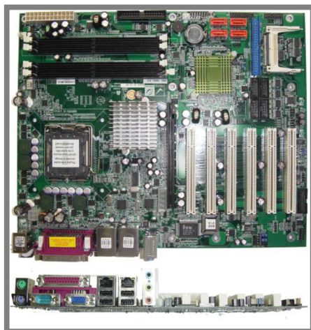
Obr. 10 ATX základní deska, [17]
