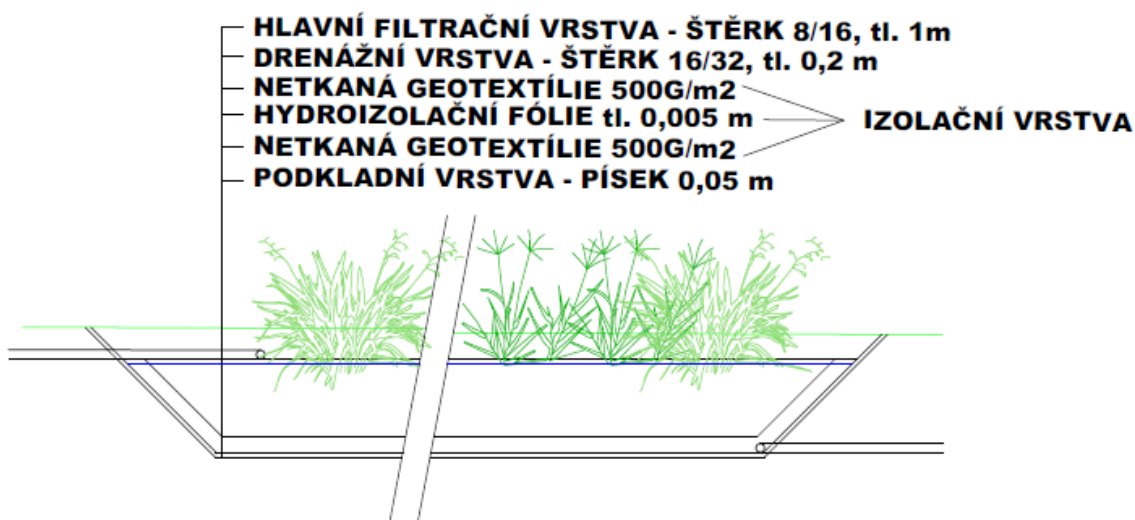
Obr. 32 Vrstvy horizontálního filtru
