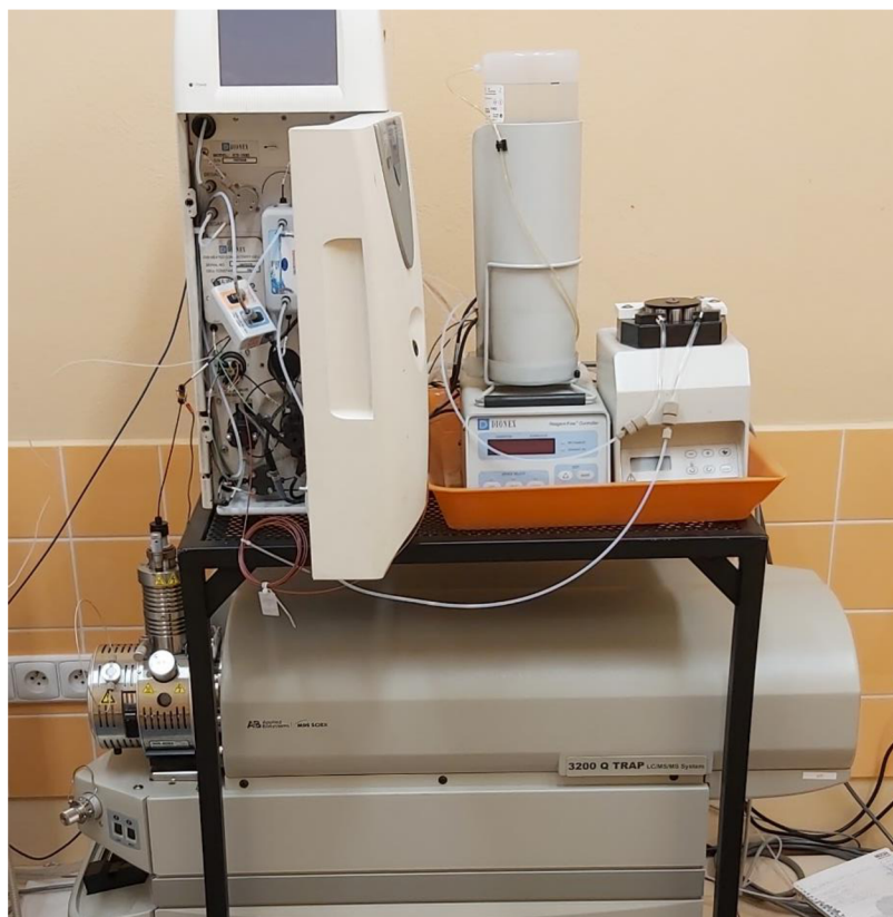
Obrázek č. 1, Iontový chromatograf IC-1600 (na stolečku) s hmotnostní spektrometr s ionizací v elektrospreji 3200 Q TRAP (pod stolečkem)
