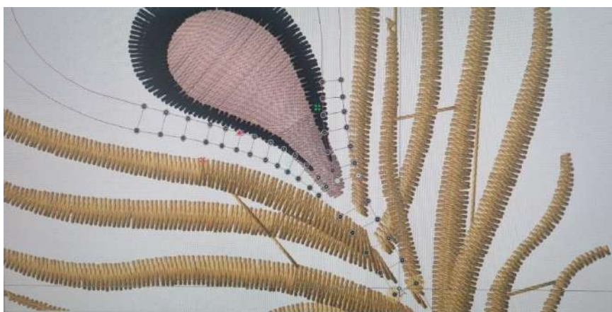
Obrázek 18 Zadávání směru stehů v programu Tajima [vytvořeno autorem]
