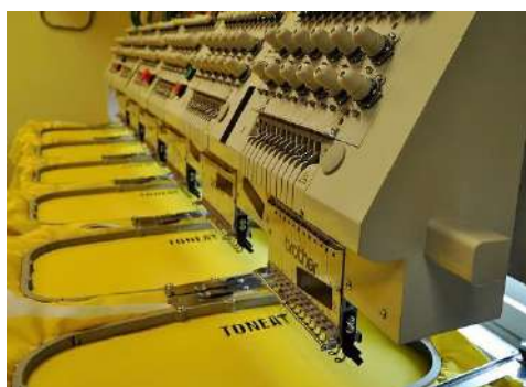
Obrázek 29 - Šestihlavý vyšivací stroj ze začátku 21. století [3]
