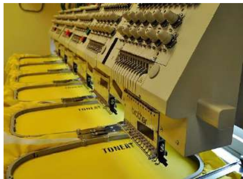
Obrázek 6 Šestihlavý vyšívací stroj ze začátku 21. století [3]
