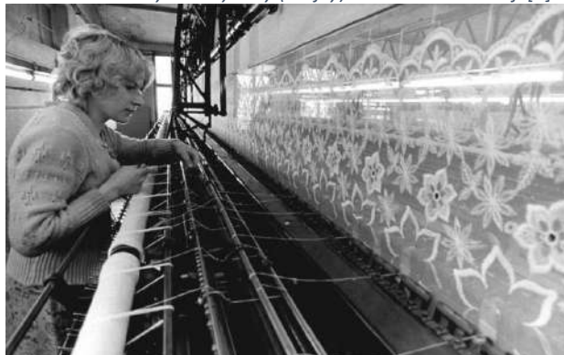
Obrázek 28- Krajka vytvořená na člunkovém stroji [3]
