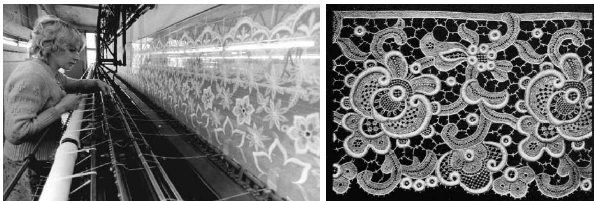
Obrázek 4 Výroba výšivky (krajky) na člunkovém stroji [3]
