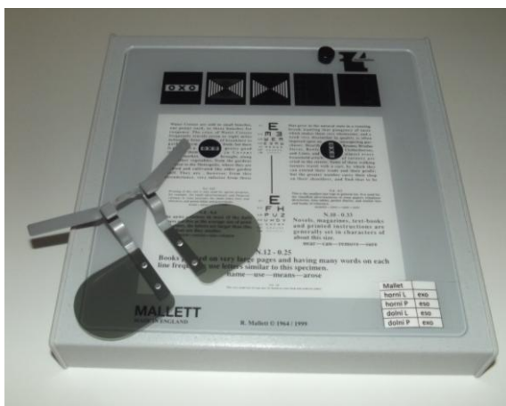
Obr. 6: Malletova jednotka s polarizačními brýlemi
