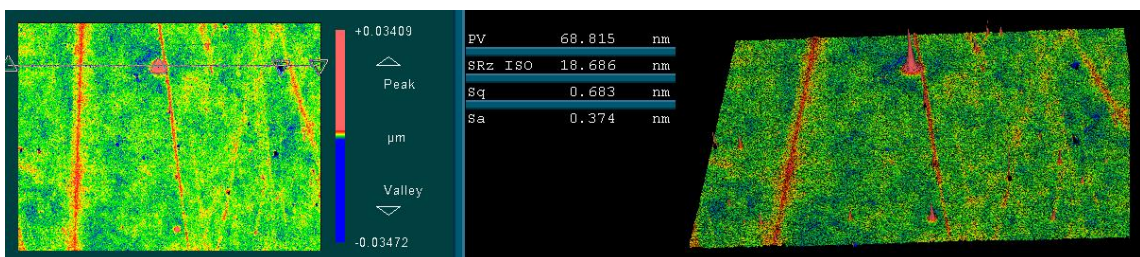
Obrázek 5.6: Snímek z white-light interferometru pro vrstvu SiO 2 , rychlost tažení vrstvy 7 cm/min, objektiv 50x.
