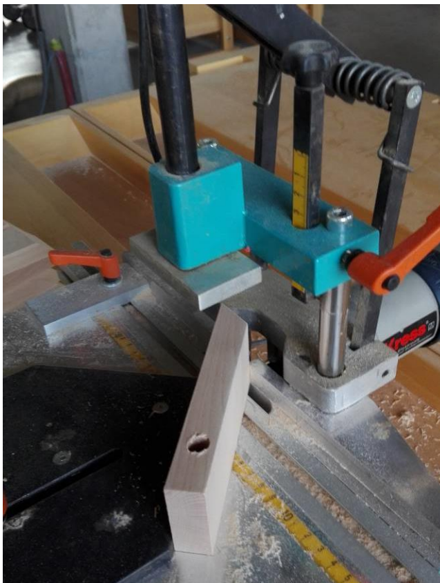
Obr. 36: Vytvoření drážky pro spojky pomocí frézky
