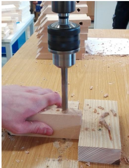
Obr. 35: Vytvoření otvoru pro upínací čelisti
