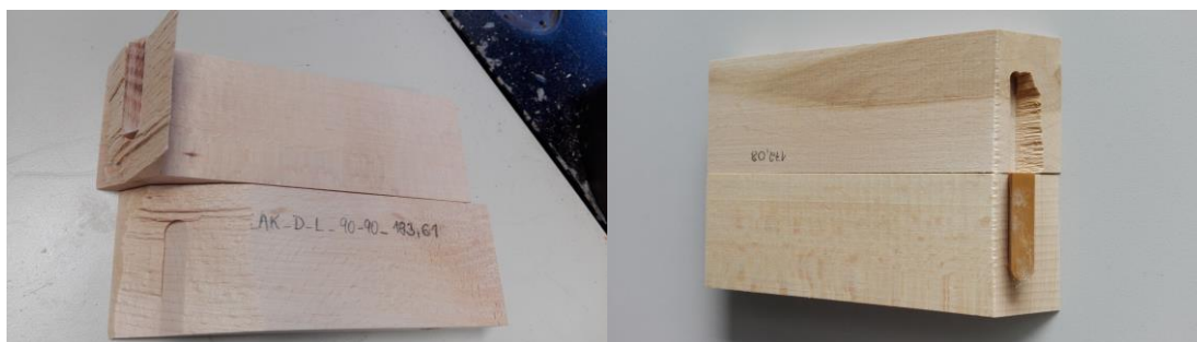
Obr. 46: Porušení spoje s dřevěnou a plastovou spojkou
