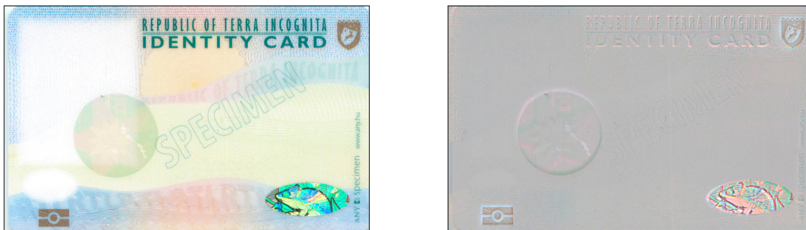
Obrázek 5.3: Součástí předzpracování dat bylo zarovnání všech kartiček vůči společnému vzoru a následně spočítána střední hodnota pro každý pixel. Od každé kartičky byla následně střední hodnota odečtena. Tímto jsem zvýraznil případné anomálie. Na levém obrázku je původní kartička, na pravé straně je potom kartička s odečtenou střední hodnotou.
