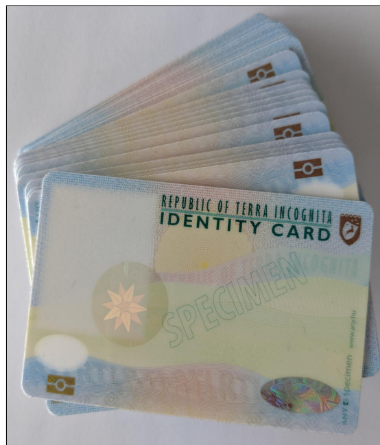
Obrázek 5.1: Na obrázku je ukázána řada plastových kartiček, kde každá obsahuje vadu vzniklou při její výrobě. Jedná se v nejčastějším případě o kontaminaci prachovými částicemi nebo vlisovaná vlákna. Defekty jsou často velice malé a nezřetelné.
