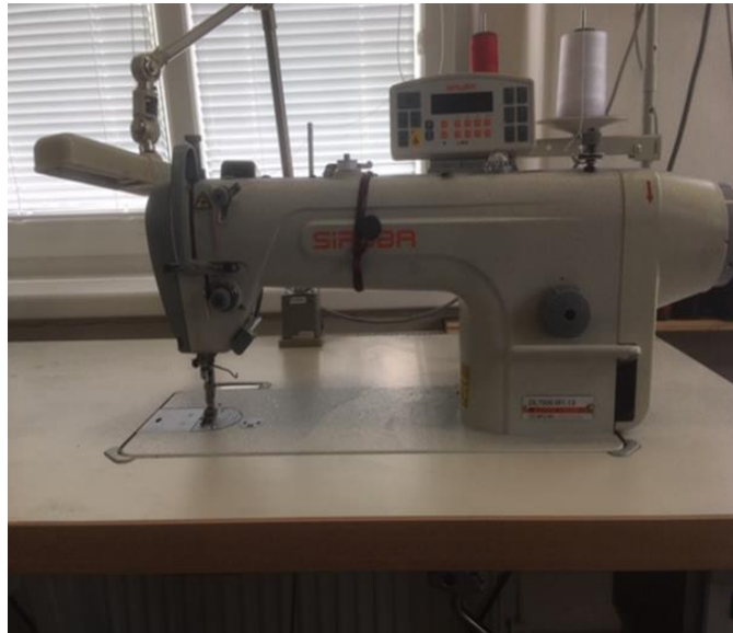
Obrázek 42: Šicí stroj Siruba DL 7000 M1-13(dvounitný vázaný steh)
