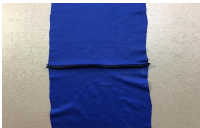
Obrázek 43: Ukázka vzorku pro testování (čtyřnitý obnitkovací steh)
