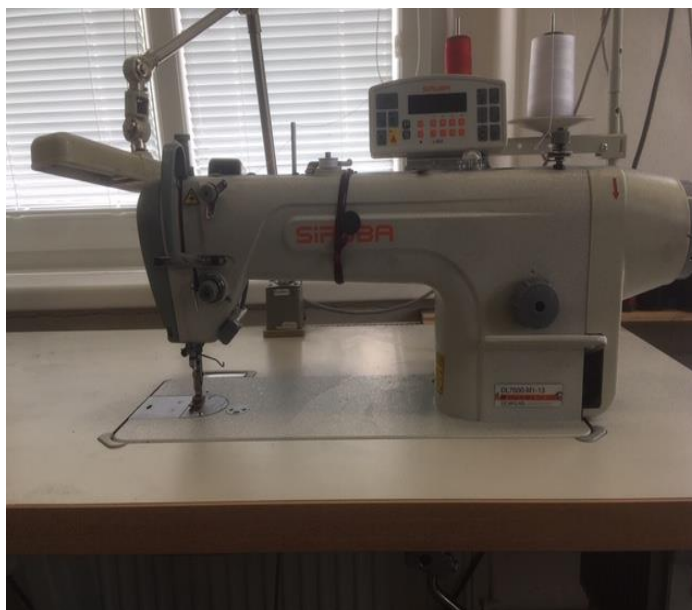
Obrázek 30: Šicí stroj Siruba DL 7000-M1-13 (dvounitný vázaný steh)
