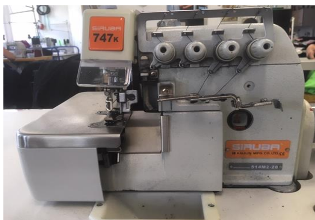
Obrázek 44: Šicí stroj Siruba 747k (čtyřnitý obnitkovací steh)
