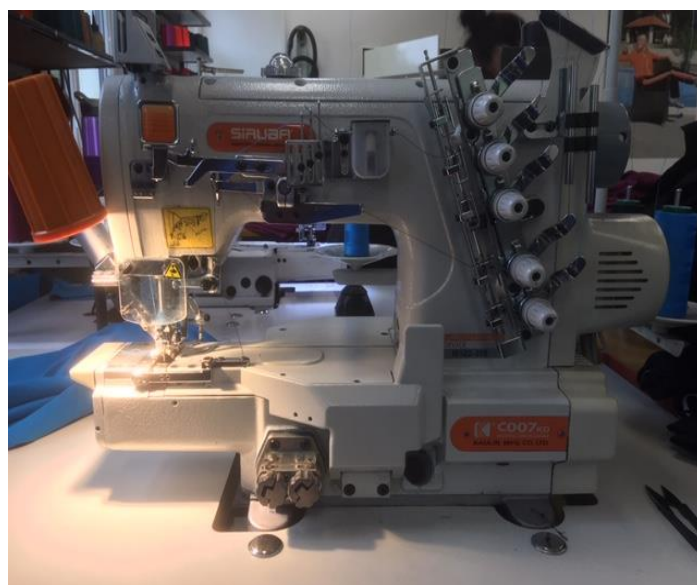
Obrázek 35: Šicí stroj Siruba C007KD (pětinitný spodem i vrchem krycí steh)
