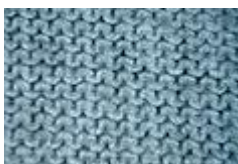
Obrázek 4: Jednolícní hladká vazba (rub) [12]
