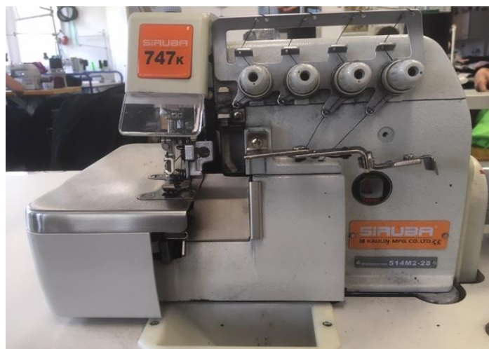
Obrázek 34: Šicí stroj Siruba 747k (čtyřnitný obnitkovací steh)
