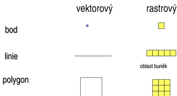
Obrázek 4: Reprezentace vektoru a rastru zdroj: http://wiki.cs.vsb.cz/images/8/8f/Gis_pr_2.pdf
