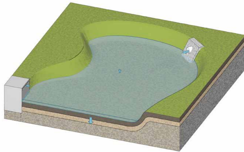
obr. 24 - schématické zobrazení vsakovací retenční nádrže, Voda ve městě (2021)
