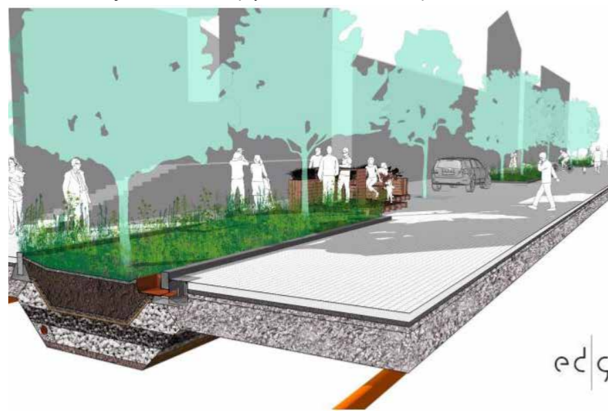
obr. 12 - schéma využití podzemních vrstev strukturálních substrátů, dostupné z: https://bluegreengrey.edges.se
