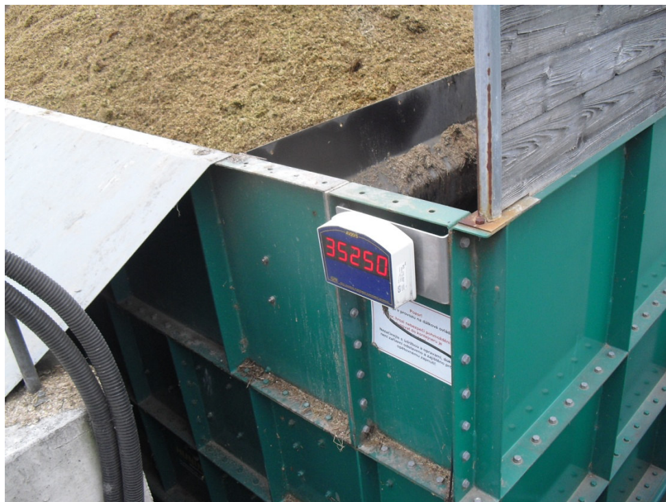
Obrázek č. 2 – Váha na dávkovači substrátu (Zdroj: autor)
