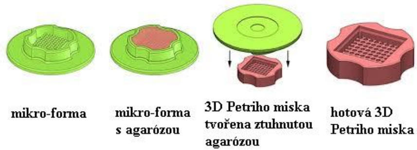
Obr. 10 – Postup přípravy agarózové 3D Petriho misky (Převzato a překresleno z http://www.microtissues.com )
