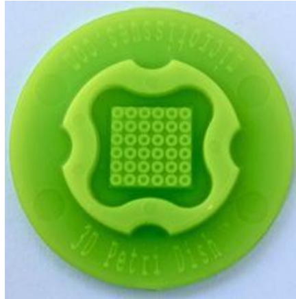
Obr. 9 – Mikro-forma firmy Microtissues pro přípravu 3D Petriho misky z agarózy (Převzato z http://www.microtissues.com )
