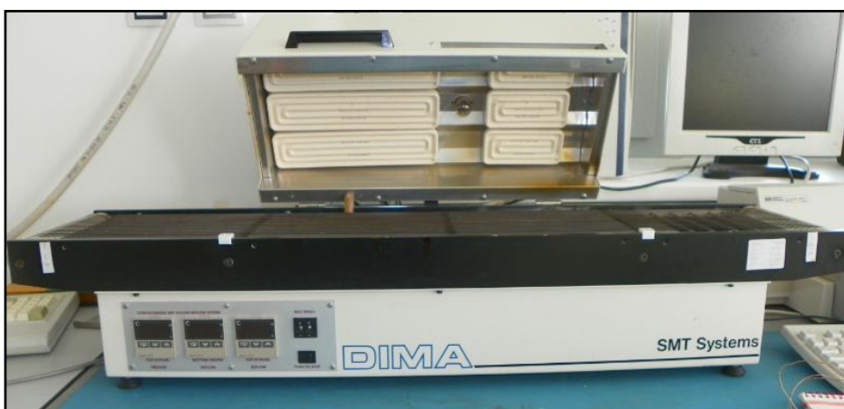
Obr. 8: Průběžná přetavovací pec DIMA SMRO 0180
