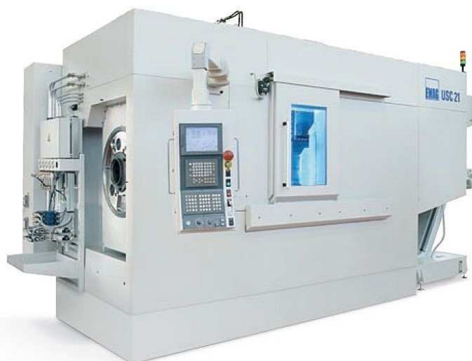
Obr. 3.15 – Tlumení Mineralitu a stroj se základem z Mineralitu [40]
