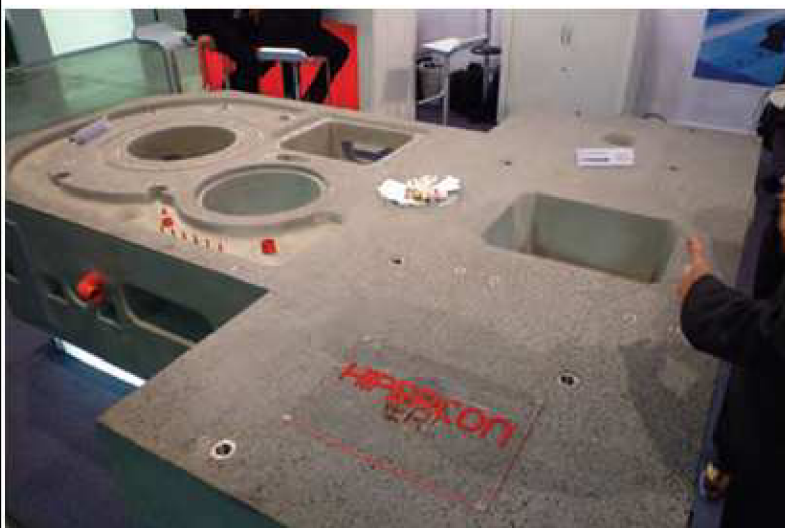
Obr. 3.10 - Lože z HYPERCONU firmy TOSHULIN [9]
