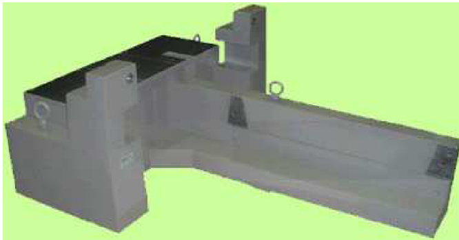
Obr. 3.5 – Základ obráběcího stroje z Celithu firmy Microplan Group [33]
