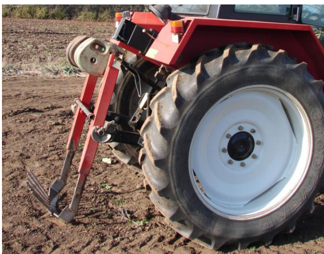
Obr. č. 18: Mechanizační prostředek pro sklizeň sazenic – vyorávač [13].
