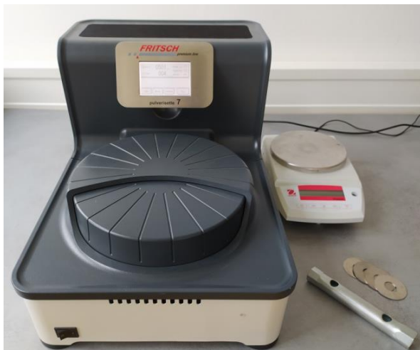
Obrázek 5.5: Pracoviště s planetárním mlýnem – vlevo, mlecí miska s ocelovými kuličkami a vzorkem – vpravo.
