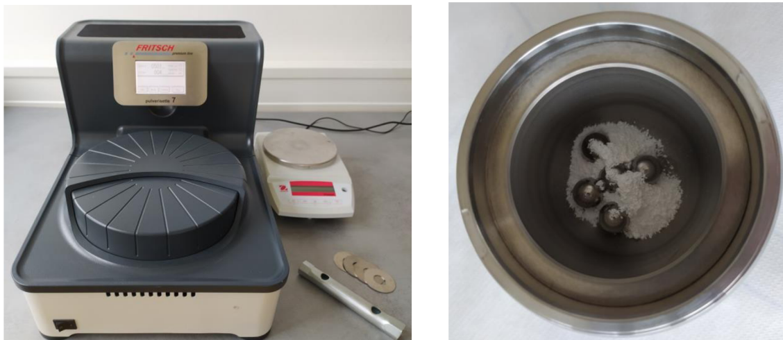
Obrázek 5.5: Pracoviště s planetárním mlýnem – vlevo, mlecí miska s ocelovými kuličkami a vzorkem – vpravo.
