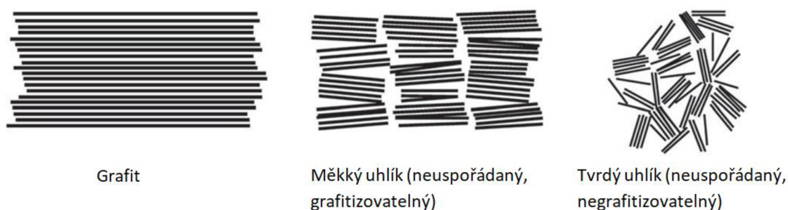
Obrázek 3.3 Vyobrazení struktury grafitu, měkkého uhlíku a tvrdého uhlíku. [16]
