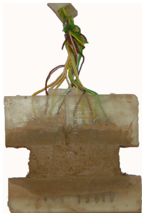
Obr. 6.6: Napastovaná elektroda připravená k měření
