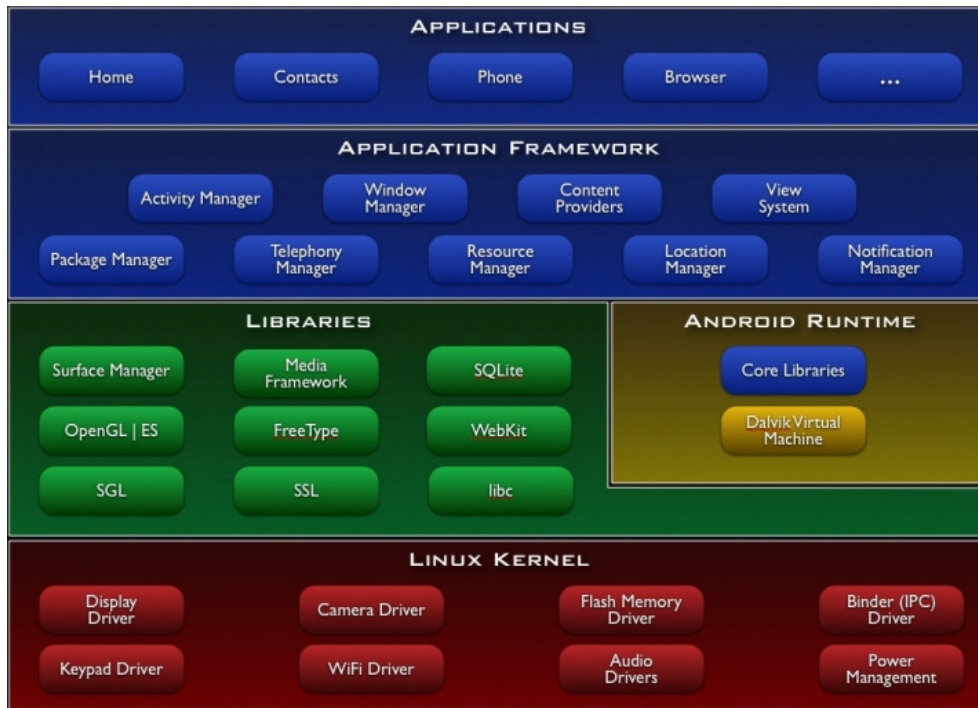
Obrázek 3.1: Architektura platformy Android [2].
