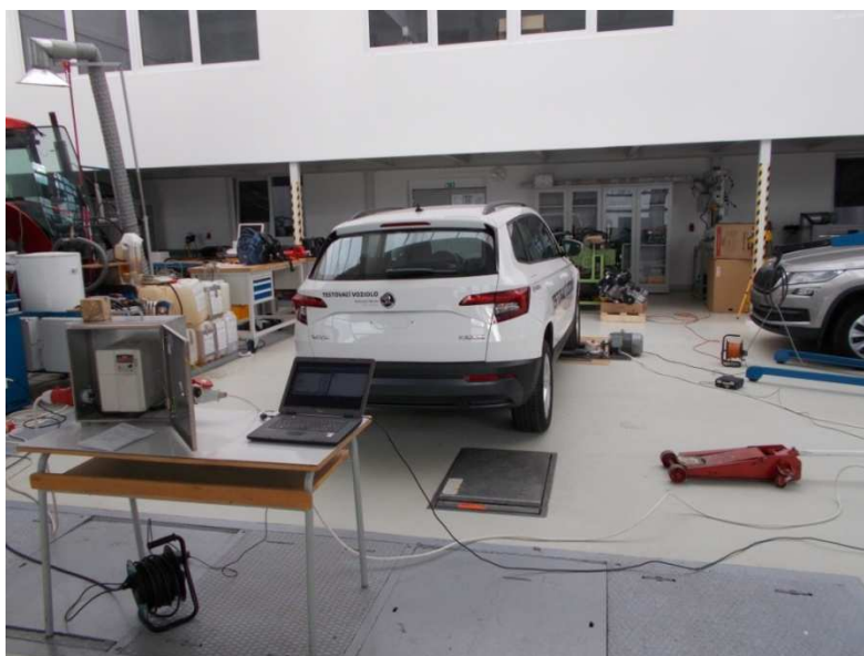
Obr. 11 - Měření brzdné síly[autor]
