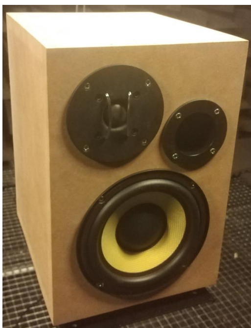
Obr. 5.1 Realizovaná dvoupásmová ozvučnice.
